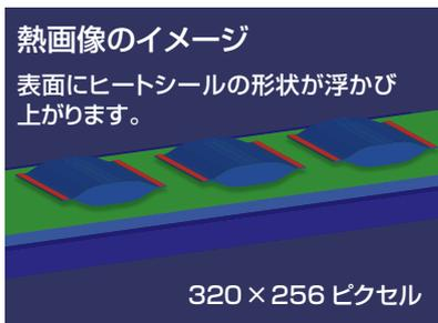
ヒートシールの不良は、内容物を充填後に包装を密封する際に多く発生し、複数の不良発生パターンがあります。良否判定システムは包装の最終工程である、ヒートシール密封工程でその威力を発揮します。縦型ピロー包装機はもちろん、横型ピロー包装機にも小型サーモグラフィが設置可能であれば適用できます。
